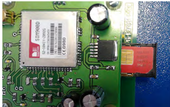
Фото 16.1. Установка лотка на место
